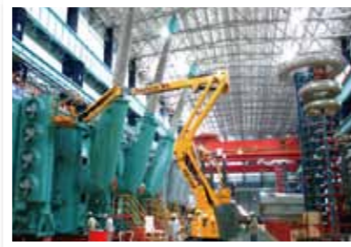
正在组装的大型变压器
